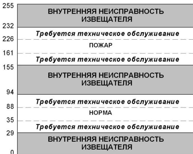
При измерении текущего значения аналогового параметра извещателя ALG-EN оно должно лежать в диапазоне от 35 до 88 единиц. В противном случае эксплуатация извещателя не допустима.
