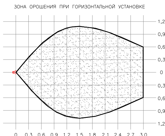
Рисунок 3.7 Карта орошения ОПР-375П при горизонтальной установке на высоте 0,6 м
