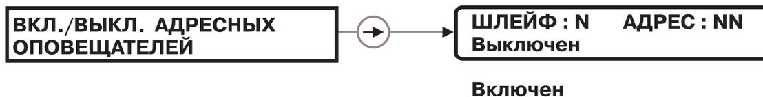
В данном пункте меню производится тестирование адресных оповещателей и модулей управления по вызову. Чтобы включить адресный оповещатель или модуль нужно выбрать № шлейфа и № адресного устройства, установить **ВКЛЮЧЕН** и нажать **ввод** — адресное устройство включится. По окончании проверки необходимо установить **ВЫКЛЮЧЕН** и нажать **ввод** — адресное устройство выключится.
